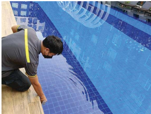
ภาพที่ 3.5.4-2 การตรวจวัด pH, \text{Cl}_2 สระว่ายน้ำ
