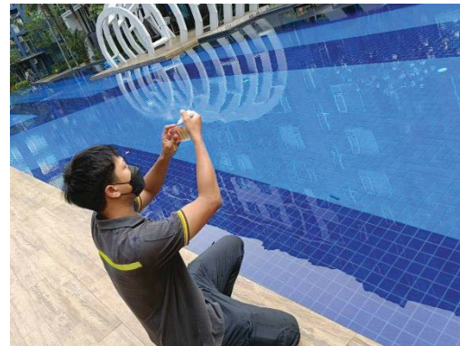
ภาพที่ 3.5.4-2 การตรวจวัด pH, \text{Cl}_2 สระว่ายน้ำ
